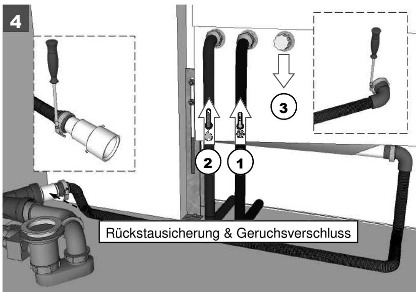
Kalt- und Warmwasseranschluss (1) und (2) herstellen. Falls erforderlich, externen Auslauf anschließen (3), wenn dieser nicht auf Trägerplatte montiert ist. Ablaufschlauch am Schlauchkasten und an Abflussleitung anschließen.
