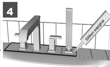
Fliesen bohren, ggf. zuschneiden und auf der Armatureträgerplatte mit einem aushärtenden Kleber anbringen (3). Anschließend erfolgt die Montage der Armatur gemäß entsprechender Montageanleitung. Einsetzen der gefliesten Trägerplatte in Montagerahmen und ausfüllen der Fuge mittels essigsäurefreiem Silikon (4).
