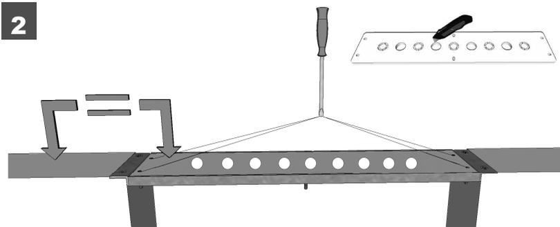
Armatureträgerplatte in den Montagerahmen einlegen. Die Höhe und die Höhengleichheit kann mittels der 6 Stellschrauben justiert werden.
