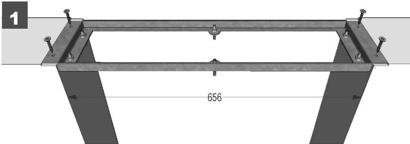
Montagerahmen auf Mauerwerk einhängen, ausrichten und befestigen. Mindestabstand zwischen Wand und Wannenrand **140mm**.
