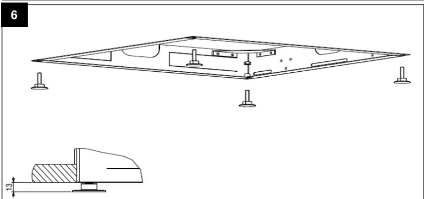
**Montagehinweis:** Beachten Sie die Rahmengrößen auf Seite 11. Bei nachträglicher Montage gelten die angegebenen Ausschnittmaße. In diesem Fall, ist der Spalt zwischen Ausschnitt und Rahmen bauseits zu verschließen. Beim Einbau in eine Massivdecke die Haltetaschen des Einbaurahmens entfernen.
