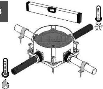
Positionieren und fixieren Sie die Box mittels Schellen im Boden. Installieren Sie Heiß- und Kaltwasserleitung. Anschließend führen Sie einen Drucktest durch.
