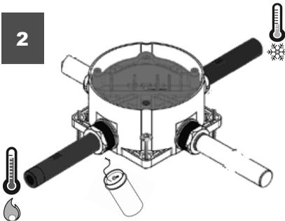
Langnippel in die markierten Zuläufe (warm und kalt), sowie Blindnippel in die beiden übrigen Anschlüsse eindrehen (eindichten).
