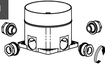
Alle 4 Gewindenippel mit Formdichtung eindrehen.
