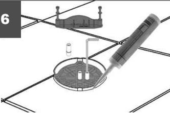
Nach erfolgter Fertigstellung des Bodenbelags, erfolgt die Anpassung des Kunststoff-Teils an das Bodenniveau und das Abdichten des Spaltes zwischen Box und Belag mittels Silikon (essigfrei).
